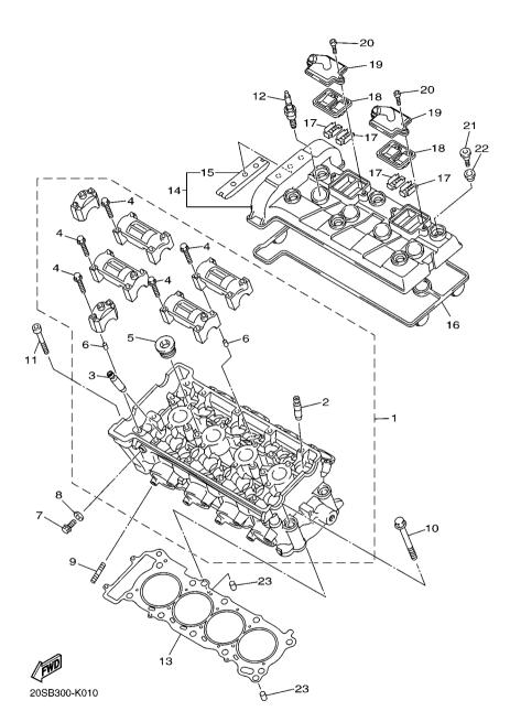
FIG. 1 CYLINDER HEAD
