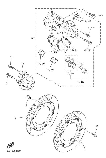
FIG. 30 FRONT BRAKE CALIPER
