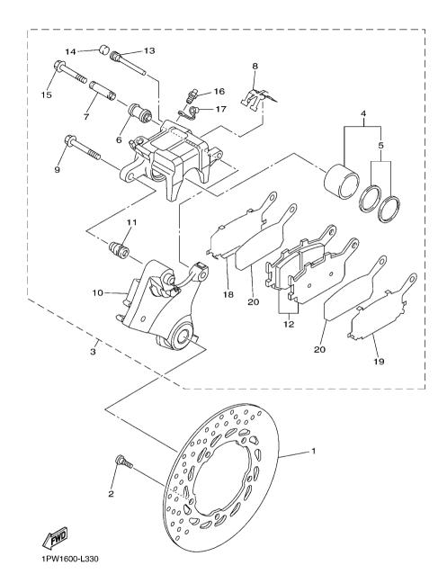
FIG. 32 REAR BRAKE CALIPER
