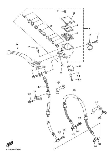
FIG. 34 FRONT MASTER CYLINDER
